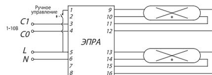
Схема включения двухламповая с ЭПРА, с управлением
