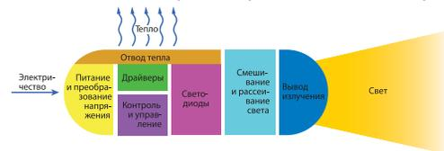
Для использования в целях освещения LED должны быть объединены в систему, включающую собственно светодиоды, оптику, драйверы, источники питания, теплоотводы, корпус, узлы крепления и кабели. Все названные компоненты присутствуют в световом приборе.
