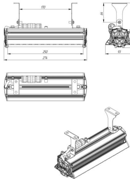
Рисунок 2 Светильник «L-industry 30 Turbine» с поворотным креплением.
