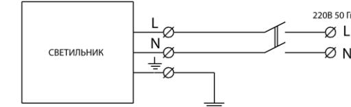
Рисунок 3 Схема подключения светильника
