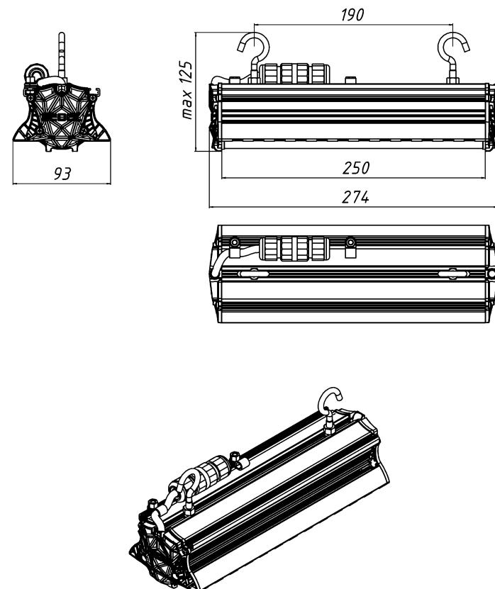
Рисунок 1 Светильник «L-industry 30 Turbine» с подвесным креплением.
